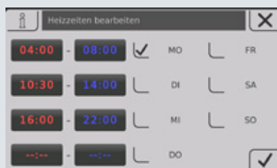
Abb. 2 Ansicht der Heizzeiten (individuell einstellbar)
