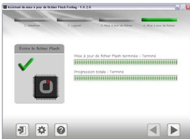
**REMARQUE ! À cette étape, ne pas terminer la mise à jour et ne pas couper la connexion avec la commande de la chaudière !**
